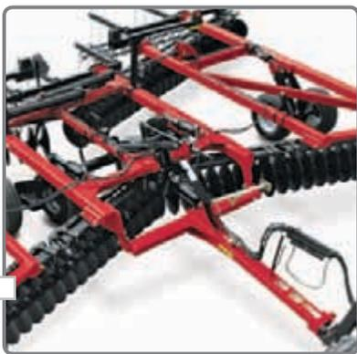
**Тяговая рама** оснащена увеличенной секцией тяговых пластин и трубами с толщиной стенок 9,5 мм для обеспечения повышенной надежности.
