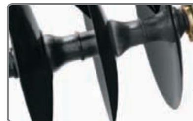
Ножи из стали **Earth Metal®** имеют профилированный центр для повышения прочности и неглубокую вогнутую поверхность для улучшения проникновения в почву с минимальным уплотнением. Для обеспечения более высокой прочности и надежности ножи монтируются на втулки из чугуна с шаровидным графитом.
