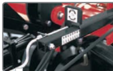
**Одноточечная гидравлическая система контроля глубины с приводом от кривошипа** проста и точна в эксплуатации, а также значительно сокращает время, необходимое для настройки глубины в различных полевых условиях.
