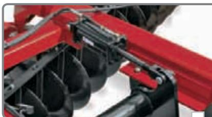
**Ось качания, захваты и угловые крепления** обеспечивают более высокую прочность для веса и размера дисковых борон модели True-Tandem 370.
