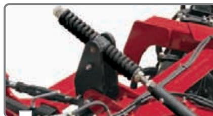
**Более жесткие пружины** обеспечивают устойчивость при транспортировке и снижают «раскачивание». При этом не потребуется повторно выровнять машину при переводе ее из полевого режима в транспортировочный.
