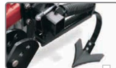
Для полей с высоким содержанием пожнивных остатков выберите 3-рядную зубчатую борону с более эффективной обработкой пожнивных остатков и высоким прижимным давлением.
